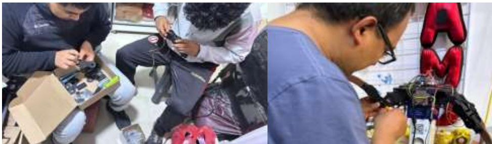
Figura 5. Ensamblaje de las patas articuladas del hexápodo.
